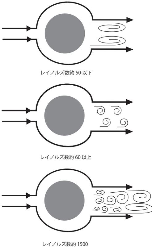
このように渦の様子が把握できて何が嬉しいのかと言うと、飛行機が空中を飛行している時や架橋周辺で風が吹いているとき、飛行機や架橋の後方にはカルマン渦が発生しており、建造物は渦の振動の影響を受けます。飛行機や架橋の設計ではこのような渦の影響を考慮する必要がありますが、機体や橋を造
