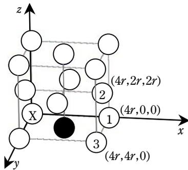
上図のように原点にXを置きます。単体格子の辺に沿って座標を設定します。X に近接する原子を一つ見つけ(図の●),さらにそれに接する原子を探します(図の1~3)。原子半径を  $r$  とすると,1~3 の座標は図中に示した通りになります。座標が分かりますので,当然 X からの距離は分かりますね。
