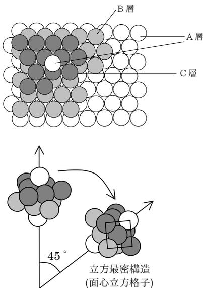
ですので、以下のように面心立方格子も六方最密構造と共通の図を用いて考えることができます。数えるべきはイ〜ニとト・チです。
